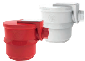
180.X.000010 - Scatola morsetti BC materiale: PP 180.X.000020 Scatola morsetti BC/L materiale: PVDF
