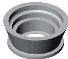
180.X.000050 - Manicotto HM Per fissaggio su barre di supporto trasversali con temp. elevate del liquido (> 60°C) o forte vaporizzazione nella parte inferiore della scatola. Diametro del foro 70 mm - 76 mm. Materiale: EPDM
